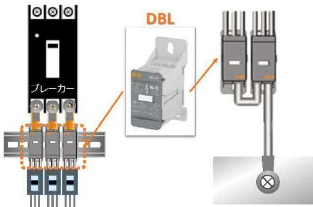
✓ 丸型端子の圧着加工不要で工数削減
